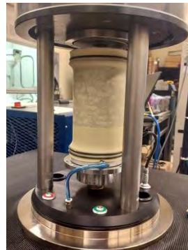
Stress Sweep Rutting(SSR) AASHTO TP 134-22
