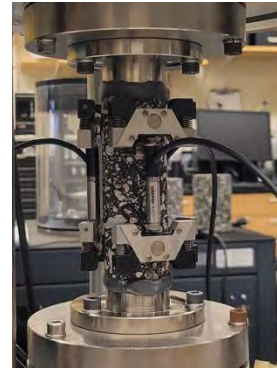
Cyclic Fatigue Test AASHTO TP 133-19
